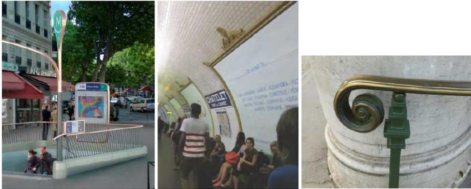
Le socle en pierre, ou la « plinthe urbaine », est travaillé comme un objet précieux, en facettes, et permet de répondre à des besoins techniques, tels que supporter le garde-corps, retenir les eaux pluviales. Il souligne les contours de la trémie en filiation avec le réseau historique.
